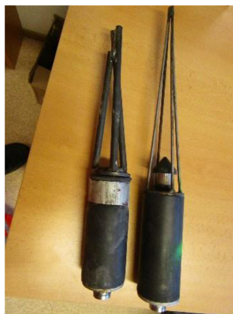
Figur 10 Forsterka låsing av gummi på pakker til venstre og påsveisa styrepinner til høyre.
