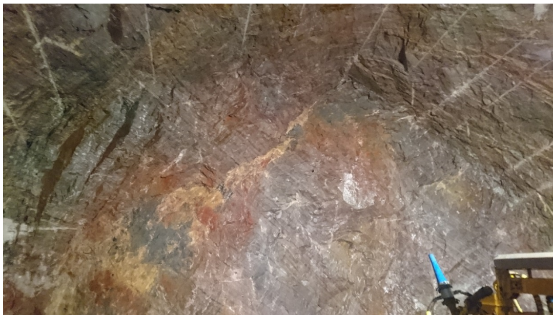
Figur 7 Kvartsitt med tynne sprekker fylt med leirholdig materiale
