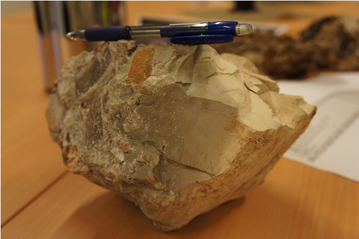
Figur 21 Injeksjonsement som er størknet i et åpent rom i svakhetssone (brenksjesonen)
